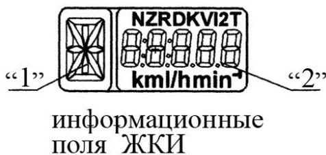
1. цифровое обозначение положения переключателя коробки передач (цифры от 0 до 6) или буквенное обозначение положение переключателя редуктора (буквы L, M, H, N)
